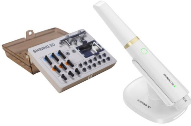
Şekil 4. İntraoral fotogrametri cihazı (Aoralscan Elite IPG, Shining 3D, Çin)
